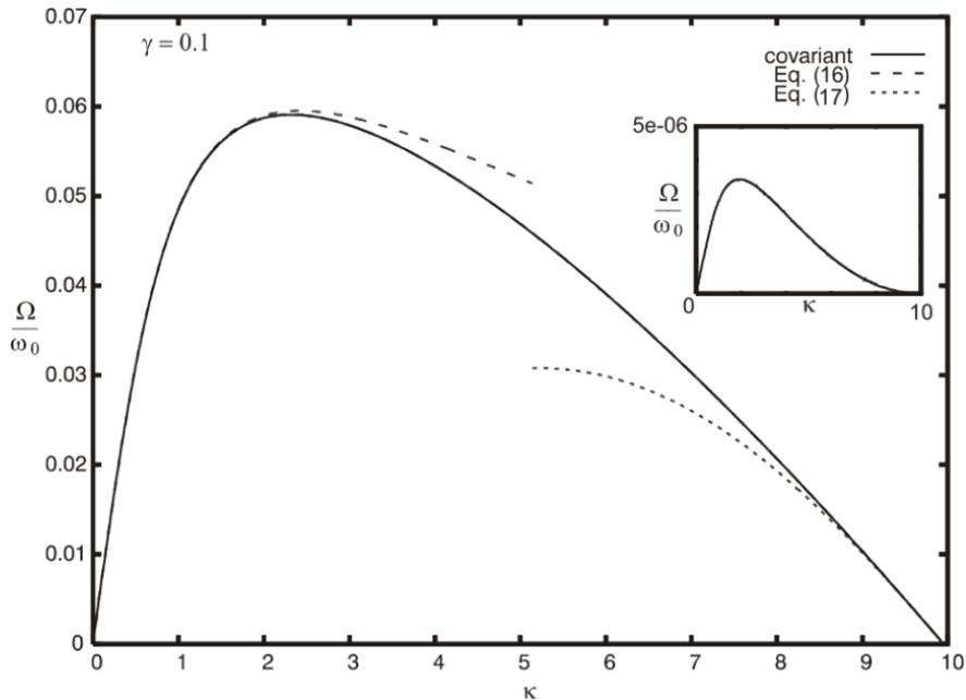
Abbildung 3: Die Wachstumsrate  $\Omega/\omega_0$  für  $\gamma = 0.1$ . Eingefügt ist die Differenz zwischen kovarianter (11) und nichtkovarianter (12) Lösung.
